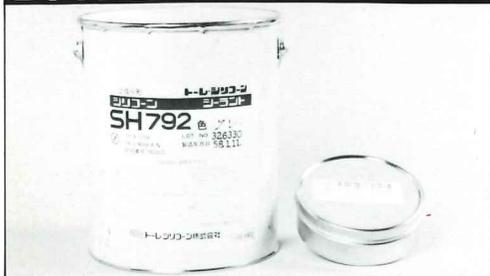
新しい時代の要求に応じてつくり出された弾性シーリング材、建築・土木用シーラントは動きの大きな目地に最適です。カーテンウォールのパネルの目地やマリオン、笠木の目地、土木用長大スパンのジョイントの動きに対する追従性にも優れています。また接着面に対する応力集中が小さく、接着安定性をもっているため、ガラスまわり、サッシまわりにも最適です。そのうえ無酸型ですから金属やコンクリートを腐食させず、耐候性・耐熱性ともに抜群。伸長・圧縮のくり返しにも優れた性能を発揮いたします。
